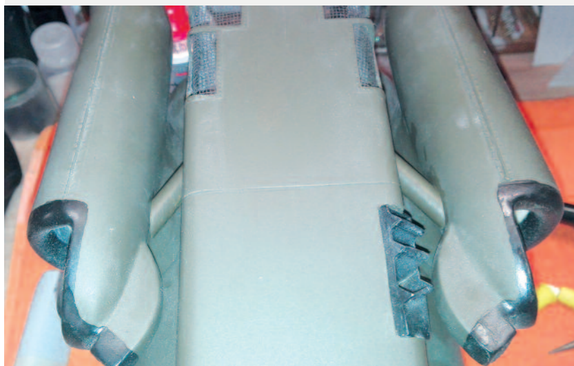
Das Doghouse mit APP-Turbinenauslass, Wellentunneln und Turbinengondeln im Rohbau.
