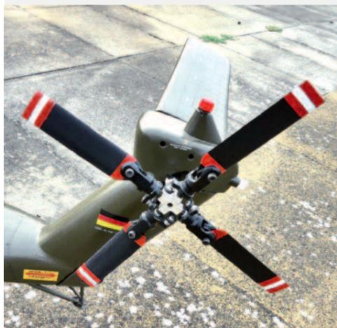
Der Sechsbblatt-Hauptrotorkopf stammt von [www.aeroconcept.fr](http://www.aeroconcept.fr), die Rotorblätter von MicroHELIS. Hinsichtlich Vierblatt-Heckrotorkopf wurde ich in den USA bei CNC Helicopter ([www.cnchelicopter.com](http://www.cnchelicopter.com)) fündig.
