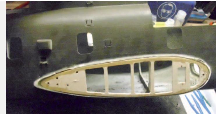
Der Hilfsrahmen für das Fahrwerk wird im Rumpf verklebt.
